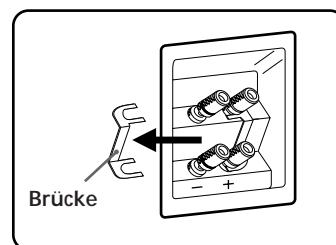
Vor dem Anschließen die Brücke entfernen.
